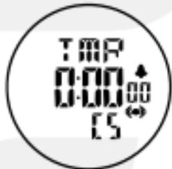
Se o cronômetro já não estiver correndo (funcionando), pressione o botão Lap/Reset (Volta/Resete) para resetar o tempo pré-ajustado.
