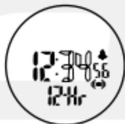
Depois, pressione o botão Start/Stop (Inicia/Para) para avançar os dígitos selecionados. Pressione e segure por 1 segundo para avanço automático. Pressione o botão Lap/Reset (Volta/Resete) a qualquer momento para salvar as alterações e sair do modo de ajuste de hora.
