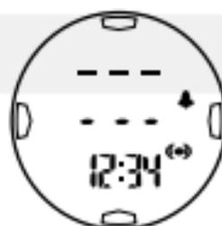
Se o sinal magnético for interrompido na amostragem, o ícone "distortion" (distorção) se manterá piscando no mostrador. O mostrador voltará ao normal quando nenhuma interferência aparecer.
