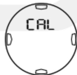
No modo de calibragem ativo, se nenhum botão for pressionado em até 30 segundos, irá automaticamente completar e retornar à dimensão da bússola. Se a calibragem não começar, pressione o botão Lap/Reset (Volta/Resete) para pular a calibragem e retornar ao modo bússola.
