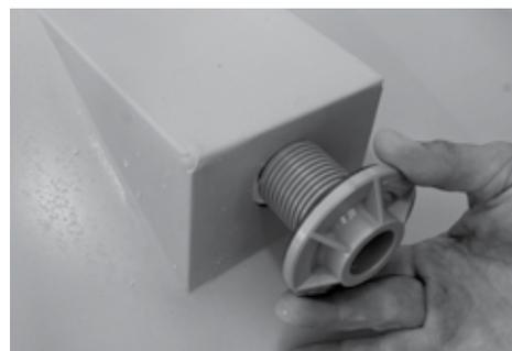
**PASSO 4** Em seguida, inicie a fixação das flanges.
