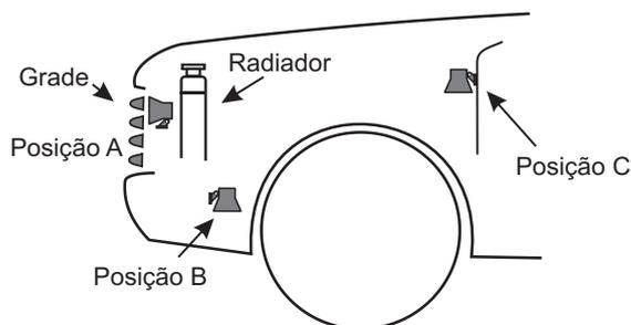
Se não for possível instalá-la neste ponto, pode-se conseguir bons resultados montando-se a corneta sob o paralamas dianteiro, à frente da roda e voltada para baixo (posição B). Finalmente, quando nenhuma destas posições for viável, a corneta pode ainda ser instalada nas paredes do cofre do motor, também voltada para baixo (posição C).
