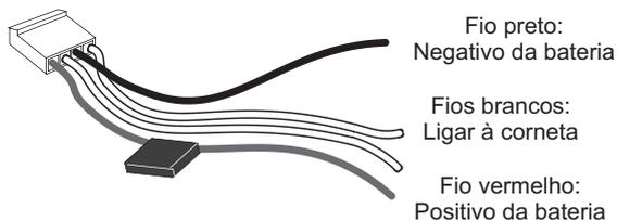
Ligue o fio vermelho ao positivo da bateria, e o preto ao chassi ou ao negativo. Ligue os fios brancos do chicote ao cabo que vem da corneta e isole bem todas as emendas. Conecte o chicote à central conforme a figura abaixo - cuidado para não encaixar o chicote invertido (ele só entra errado com muito esforço!).
