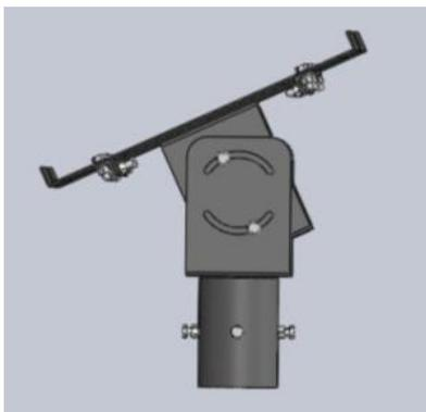
Figura 7: Base regulável. É fixada no topo do poste.
