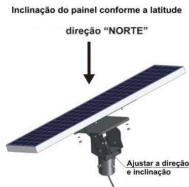
Figura 3: Inclinação do painel deve ser calculada conf. o local
