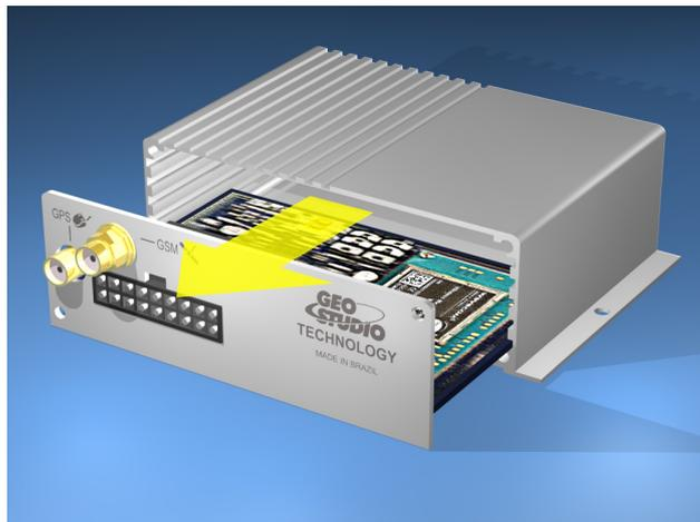
3) Gire cuidadosamente a placa de circuito impresso. O conector do chip está localizado na parte de baixo da placa.
