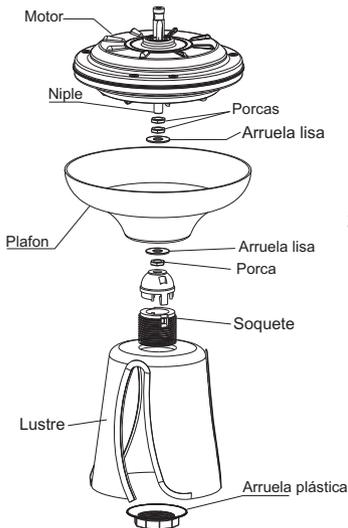
Insira o niple no motor e passe os cabos cinza em seu núcleo. Aperte-o com a porca sextavada 9,525mm x 4mm (3/8" x 5/32").
