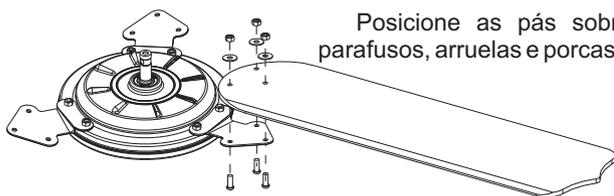
Posicione as pás sobre as garras e fixe-as utilizando os parafusos, arruelas e porcas.
