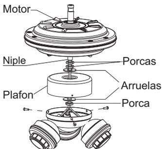
Insira o niple no motor, passando os cabos cinza em seu núcleo. Aperte-o com a porca sextavada 9,525mm x 4mm (3/8" x 5/32").
