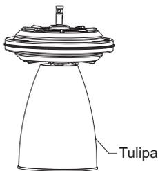
Com o soquete fixo no motor, encaixe a tulipa no soquete e gire-o até travar.
