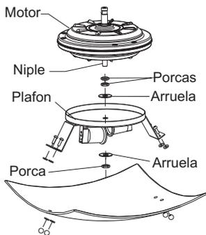
Insira o niple no motor, passando os cabos cinza em seu núcleo. Aperte-o com a porca sextavada 9,525mm x 4mm (3/8" x 5/32").
