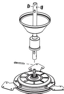
Encaixe a haste no eixo do motor, insira a cupilha e abra as pontas de forma que ela abrace a haste.
