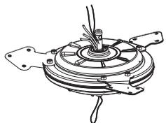
Passo o cabo preto e cinza pelo furo do eixo do motor até sair pela parte de baixo (somente para ventiladores com lustre).
