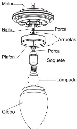
Insira o niple no motor, passando os cabos cinza em seu núcleo. Aperte-o com a porca sextavada 9,525mm x 4mm (3/8" x 5/32").
