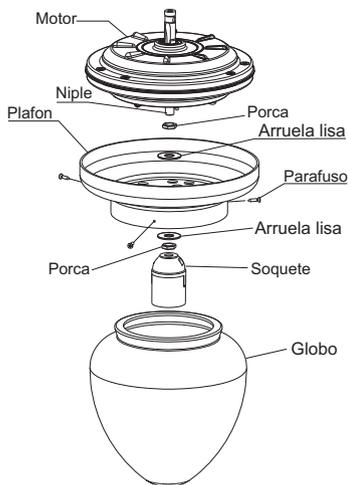
Insira o niple no motor e passe os cabos cinza em seu núcleo. Aperte-o com a porca sextavada 9,525mm x 4mm (3/8" x 5/32").
