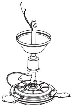
Passes os cabos elétricos do motor e da lâmpada pelo furo lateral inferior da haste e retire-os pelo furo lateral superior.
