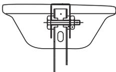
Encaixe a haste no suporte de fixação e fixe o ventilador utilizando o parafuso juntamente com a porca.
