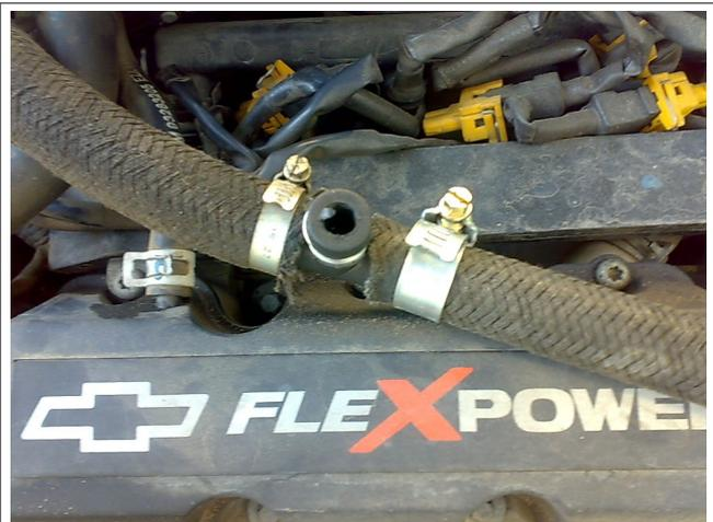
Válvula de baixa (estrangulador) em detalhe;
