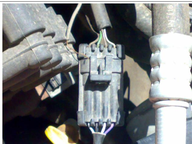
Exemplo de conector da sonda (Corsa Classic)
