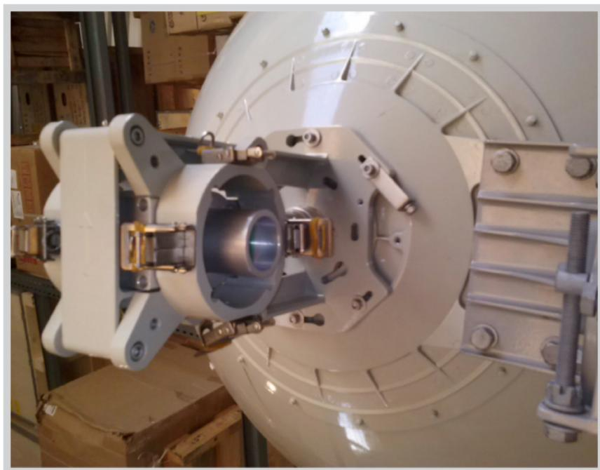
Imagem da montagem finalizada do OMT em antena wi2be.
