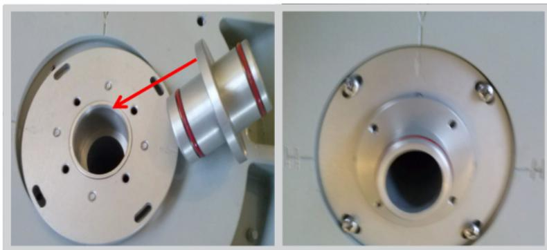
Utilizar os 4 kits de parafusos tipo Philips que acompanham a peça para fixar o adaptador do OMT no alimentador. Depois disso, fixar novamente o alimentador na antena utilizando os 4 parafusos tipo Philips retirados no passo 2.
