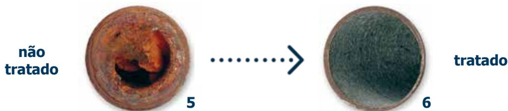
A técnica de impulso de Vulcan controla o efeito de electroforese que conduz à formação de uma camada protectora de metal e carbonato. Esta camada composta, conforme o material do tubo, por carbonato de cobre, ferro ou zinco, adere em todas as superfícies uniformes. Assim Vulcan protege todo o sistema de tubos contra ferrugem e corrosão.
