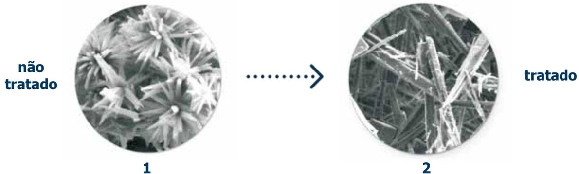
A patenteada tecnologia de impulso de Vulcan, através do processo natural da electroforese, altera o processamento da cristalização do cálcio e do magnésio. O calcário dissolvido em água tratada por Vulcan cristaliza em forma de uma "vara" monocristalina não nociva (fig. 2). Estas "varas" de cristais já não se podem unir umas às outras e fluem com a água em forma de pó.
