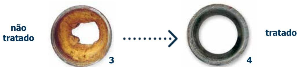
Vulcan inibe a formação de novas incrustações no tubo. O processo natural de separação agora só tem que remover as incrustações já existentes. Por conseguinte, o calcário reduz-se mais rápido do que se forma e o tubo fica sem incrustações (fig. 4). Continua a existir uma camada protectora fina, visto que o ácido carbónico só pode dissolver o calcário do calcário e não o calcário das paredes interiores dos tubos.
