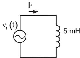
No circuito em corrente alternada da figura acima, a tensão da fonte pode ser descrita matematicamente como uma função do tempo e representada por  $v_f = 20 \cos(\omega t - 30^\circ) \text{ V}$ , em que  $\omega$  é a frequência angular da tensão.
