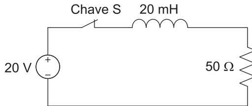
O circuito mostrado na Figura é composto por uma fonte de tensão contínua de 20 V, um indutor de 20 mH, um resistor de  $50 \Omega$  e uma chave S. Considere que a chave S é ideal e está fechada por um tempo suficiente para que o circuito se encontre na situação de regime permanente.
