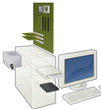
Figura 1: Componentes de um microcomputador
