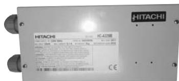
O dispositivo Harc Modbus, faz a conversão dos dados lidos em H-Link para Modbus RTU. Modbus é um protocolo de comunicação utilizado em sistemas de automação industrial, criado em 1970 pela Modicon. É um dos mais antigos protocolos utilizados em redes de Controladores Lógicos Programáveis (CLPs) para aquisição de sinais de instrumentos e comandar atuadores.
