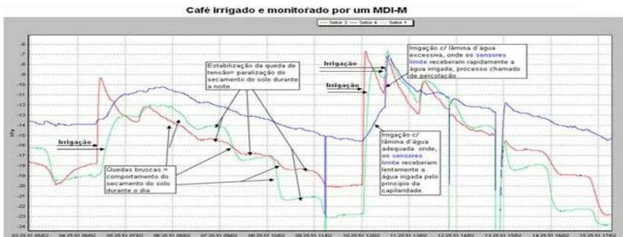
**Exemplo 4:** Monitoramento da tensão hídrica em café irrigado por gotejamento, onde o equipamento está sendo utilizado para a automação do sistema de irrigação. Neste caso a irrigação é acionada, quando a tensão hídrica chega ao secamento limite determinada pelo produtor, no caso 20KPa. A linha vermelha corresponde à tensão de água em 20 cm e a linha azul a 60 cm de profundidade.
