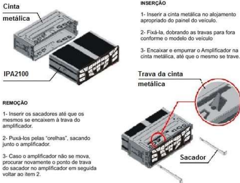
Figura 10: Inserção e remoção do equipamento no painel do veículo
