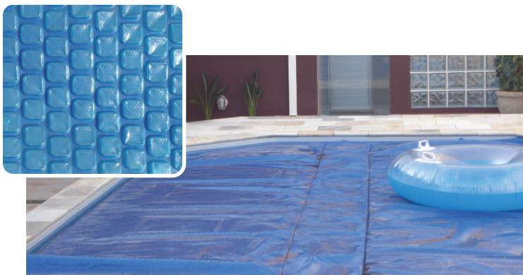
A Capa Térmica confeccionada com plástico bolha especial e deve ser instalada com as bolhas para baixo formando assim um bolsão de ar. Se a capa for feita de lona não terá o mesmo efeito, pois não forma a bolsa de ar que é a grande responsável por manter a temperatura da água.
