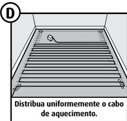
Nos locais onde há irregularidades geométricas poderá colocar o cabo de forma a cobrir esses espaços, de forma a aquecer as zonas à volta dos sanitários, etc..
