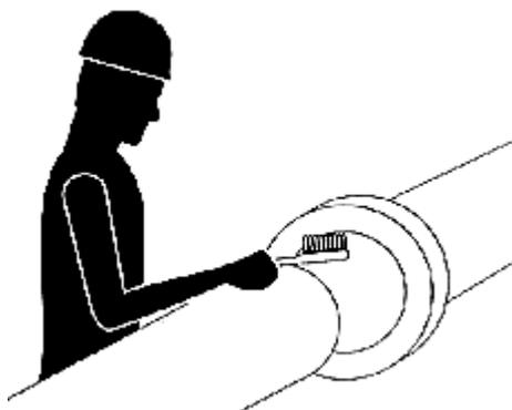
Figura 19: Limpeza do local de montagem
