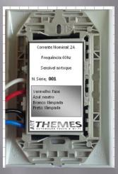
Somente ligue o disjuntor da instalação elétrica com o painel frontal já instalado para auto calibração dos sensores touch.
