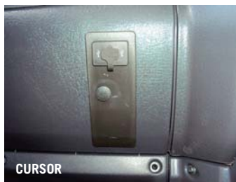
Figura 8 - Conector USB dos Veículos Stralis NR e Cursor
