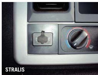
Figura 8 - Conector USB dos Veículos Stralis NR e Cursor
