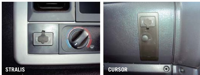
Figura 10 - Conector USB dos Veículos Stralis NR e Cursor
