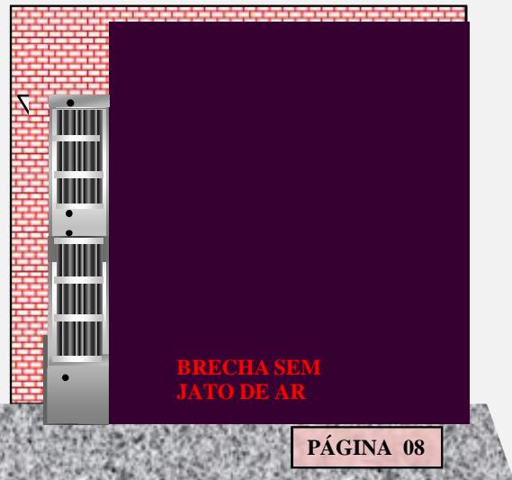
FORMA INCORRETA DE INSTALAÇÃO Rotores na vertical não ocupando todo vão livre
