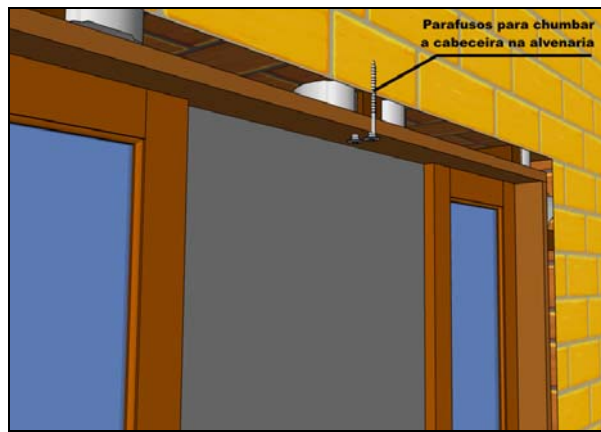
Figura 5 – Parafusos para chumbar a cabeceira na alvenaria.
