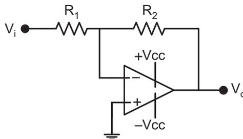
Sabendo-se que o valor de pico da tensão senoidal de entrada vale:  $V_i = 0,01\text{V}$ , e que o valor da tensão de pico senoidal de saída vale:  $V_o = 1 \text{ V}$  de pico, ambos medidos com o osciloscópio, qual é o valor em,  $\text{k}\Omega$ , do resistor  $R_2$ ?
