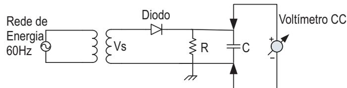
Nesse circuito, o primário do transformador é alimentado pela rede de energia elétrica de frequência  $f = 60$  Hz, e o secundário apresenta uma tensão de valor eficaz  $V_s$ . O voltímetro (CC) indica que o valor médio da tensão na carga  $R$  é muito próximo do valor de pico da senoide desenvolvida no secundário do transformador.
