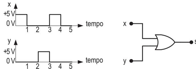
Conhecendo-se a forma de onda dos sinais de entrada x e y, mostrados na mesma Figura, qual é a forma de onda do sinal de saída s?
