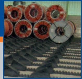
Se você deseja armazenar laminados a quente, laminados a frio, galvanizados, pintados ou placa de aço e alumínio, você pode guardá-los em um único nível ou até dois ou três níveis, existe sempre um sistema de armazenamento de bobinas Lankhorst Mouldings próprio para a sua situação.
