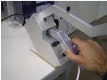
*Passo 03* – Pressione a ponta abaixando a alavanca. No final do curso, a alavanca aciona a válvula de comando, que por sua vez, pressiona o conjunto borracha de silicone e o sensor de vibração sobre o transdutor.
