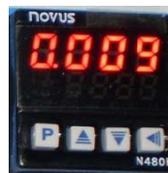
Indicação da amplitude de vibração logo após ligar o equipamento.
