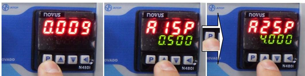
Pressionado a tecla **[P]** por alguns segundos para entrar no modo de ajuste (à esquerda), ajustando o parâmetro de detecção de teste (no centro) e ajustando o parâmetro de aceite (à direita).
