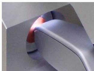
**Vista da ponta sob carga simulada pela borracha de silicone pressionada por um cilindro pneumático.**
