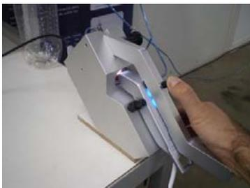
*Passo 05* – Visualize o resultado no painel da eletrônica. O display indica o valor do sinal medido e os indicadores luminosos se a ponta foi "aprovada" ou "reprovada". Observação: podem ocorrer acionamentos espúrios, contudo breves, do indicador de reprovado e do buzzer no início ou no final do teste.
