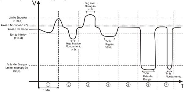
No intervalo 2 a tensão fica abaixo do limite de afundamento por menos de 3 segundos sendo considerada como um afundamento de tensão, portanto será computado um registro inválido. A mesma situação acontece no instante 3, mas com uma elevação de tensão. No intervalo 4 o registro será válido, já que a medição <u>permaceu</u> por mais de 3 segundos abaixo do limite programado.
