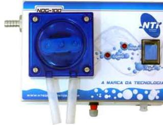
Depois de fixado e ligado, deve-se colocar as mangueiras de 3/8 na bomba peristáltica, sendo que a mangueira de entrada vem do galão do produto e a mangueira de saída deverá ser colocada no bico de injeção (conforme desenho abaixo). Na bomba peristáltica a entrada se encontra no lado esquerdo (sentido horário) e a saída no lado direito da mesma.
