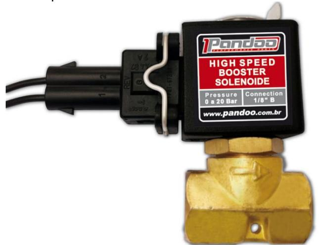
**Instale as válvulas de boost com o êmbolo para cima, e as fixe em um local que não absorvam vibrações**, a instalação correta protege contra o acúmulo de resíduos ou líquido na agulha e as vibrações podem danificar o sistema de abertura e fechamento, assim como o sistema de vedação da válvula, comprometendo seu funcionamento.
