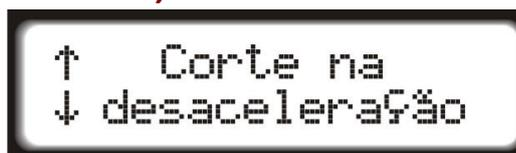
A função *CUT-OFF*, ou corte na desaceleração, é uma opção de economia de combustível e também opera como freio-motor. Ela faz com que corte a injeção de combustível quando o pedal do acelerador estiver em posição de marcha lenta e o motor em altas rotações, proporcionando também uma melhor retomada da aceleração. Muito útil para a utilização no dia a dia ou mesmo em corridas de circuito para se conseguir uma retomada limpa e rápida.
