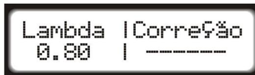
**Lambda** – para *narrowband*: valor de tensão da sonda lambda, em milivolts. Para *wideband*: valor do lambda, em  $\lambda$  (quando esse valor for superior a  $1,30\lambda$  aparecerá "High" e quando esse valor for inferior a  $0,65\lambda$  aparecerá "Low");
