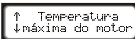
A função de alerta de temperatura do motor é um item de segurança para evitar que o mesmo trabalhe em temperaturas excessivas. Utilize esta função apenas para casos específicos e utilize apenas sensores de temperatura novos para evitar erros de leitura de temperatura. Em carros de corrida de circuito essa função evita que o motor superaquecido continue a correr e danifique de forma irreversível.
