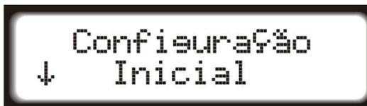
O menu de configuração Inicial deve ser o primeiro passo antes de dar partida no motor, é aqui que se executa toda a configuração do módulo, passo a passo, podendo sair do menu apenas na última tela, para que tenha certeza que todas as configurações do módulo foram realizadas.
