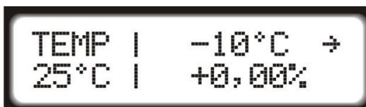
A primeira linha apresenta a temperatura do motor à qual será aplicada a correção de combustível. As temperaturas a serem aplicadas as correções vão de -10°C a 180°C.
