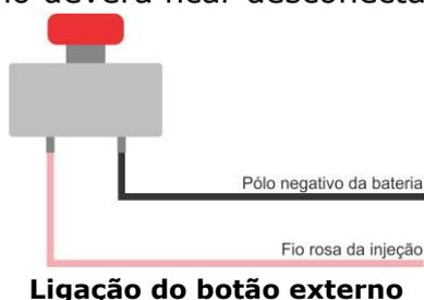
Quando o botão é pressionado o fio da injeção e o negativo da bateria entram em curto. Quando o botão estiver liberado, o fio da injeção e o negativo da bateria não se conectam.
