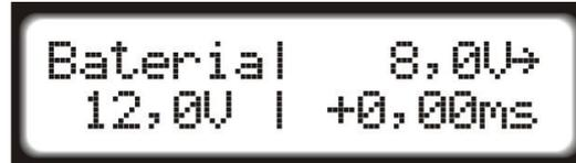
A primeira linha apresenta a tensão à qual será aplicada a correção de combustível. As tensões a serem aplicadas as correções vão de 8V a 15V.
