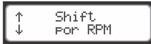
A função de controle de *shift* permite ao usuário definir algumas configurações para o acionamento de uma das saídas auxiliares em função de rotação. Esse sinal de saída pode ser utilizado para acionar qualquer tipo de equipamento, como canhão de *shift-light*, acionamento de V-Tech, acionamento de solenoides para variação de comandos de válvula, solenoide de troca de marcha para câmbios *powerglide*, bomba de combustível auxiliar, etc. O uso mais comum é para o acionamento de *shift-light*.
