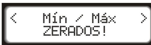
Essa função é utilizada para zerar os mínimos e máximos (Monitoramento). O único modo de executar esta função é pressionando a tecla ESQUERDA dentro do monitoramento por 3 segundos. É possível limpar tais memórias mesmo com o bloqueio de mapas ativo.
