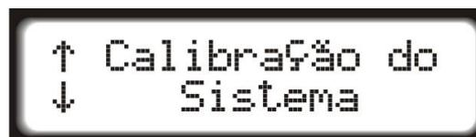
Essa função é utilizada para efetuar a calibração de todo o sistema da injeção, fazendo a calibração de todos os sensores que estiverem ligados ao sistema.
