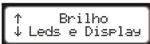
Através dessa função é possível ajustar a intensidade do brilho do visor LCD e dos LED's no MODO DIA ou no MODO NOITE. O nível de iluminação de cada modo pode ser configurada pressionando as teclas CIMA ou BAIXO em cada um dos modos.
