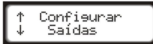
Através dessa função é possível escolher em qual fio de saída a função desejada será acionada, entre as duas saídas disponíveis. Qualquer uma dessas funções pode ser atribuída a um dos dois fios, com cores diferentes:
