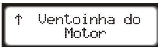
A função de controle de ventoinha do motor permite ao usuário definir algumas configurações para o acionamento de uma das saídas auxiliares em função da temperatura do motor. Esse sinal de saída pode ser utilizado para acionar qualquer tipo de equipamento. O uso mais comum é para o acionamento de eletro-ventilador.
