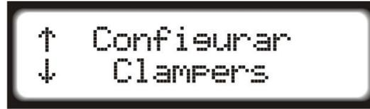
Através desse menu é possível configurar a tensão máxima de saída para cada clamber. Deve-se conectar o sensor original na entrada do **Pulser Plus** e a saída do clamber referente ao sensor ao chicote da injeção original.
