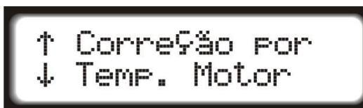
Com esse mapa é possível configurar a porcentagem de correção de injeção de combustível dos bicos injetores em função da temperatura do motor.
