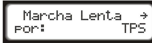
Essa função define o modo de ajuste de marcha lenta. Quando o módulo estiver configurado para "Aspirado TPS" obrigatoriamente a marcha lenta será ajustada por TPS. O tempo de injeção da marcha lenta é ajustado dentro do mapa principal de injeção.
