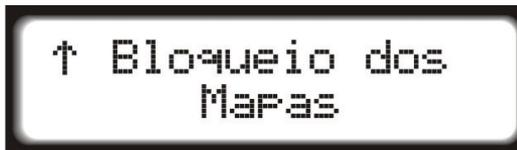
Essa função permite ao usuário criar uma senha para o bloqueio dos mapas de configurações da injeção. Enquanto a senha não for digitada, a injeção não permite que os parâmetros de configurações sejam alterados ou visualizados. Esse bloqueio oferece proteção aos mapas configurados, impedindo que pessoas não autorizadas acessem ou alterem essas configurações.
