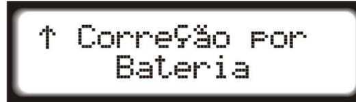
Com esse mapa é possível configurar o tempo de correção de injeção de combustível dos bicos injetores em função da tensão da bateria.
