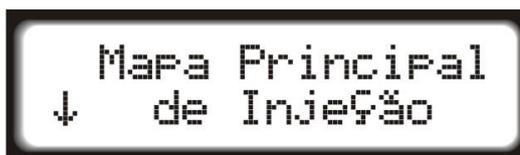
Com esses mapas é possível configurar o tempo de injeção dos bicos injetores em função da porcentagem de abertura da borboleta de aceleração, o sensor TPS.
