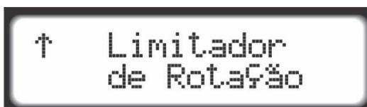
A função de limitador executa o corte do combustível ao atingir a rotação programada.
