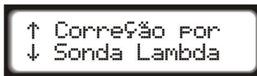
Com essa função é possível corrigir o tempo de injeção de combustível através da leitura de sonda lambda, incrementando ou decrementando o tempo total de injeção em porcentagem. Também é possível monitorar a tensão de sonda lambda de forma digital (*hallmeter* digital) ou através dos LED's frontais.
