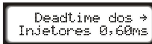
Através dessa função é possível estabelecer o tempo morto, ou *deadtime*, dos bicos injetores. O tempo morto é o tempo que o bico injetor leva para vencer a inércia de seus componentes mecânicos e começar a injetar combustível. Ou seja, é um tempo de injeção perdido apenas para a abertura da agulha de injeção.
