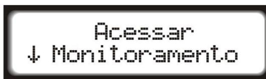
O modo de monitoramento, ou computador de bordo, tem a função de mostrar em tempo real os valores coletados pelos sensores e atuadores ligados a injeção. Assim é possível monitorar os tempos de injeção, porcentagem de abertura dos bicos, rotação do motor, entre outros. Para alguns sensores é mostrado o valor atual e os valores máximos e mínimos atingidos.
