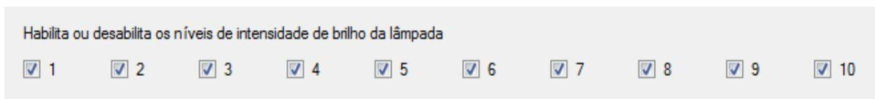
Caso a lâmpada dimerizável seja do tipo eletrônica, como uma lâmpada LED ou fluorescente, pode ser que seja necessário cortar alguns níveis de dimerização superiores, como o 9 e 10 para evitar problemas de comunicação com o MLA300, mas em muitas vezes isso não é necessário.
