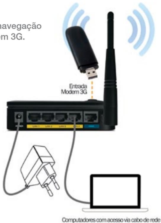
1. Conecte o Roteador Wireless 3G à fonte de energia e utilize um cabo de rede para ligá-lo ao computador.
