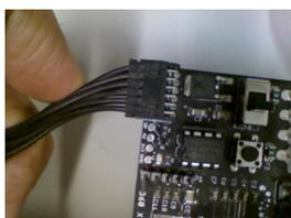
Se você irá usar seu console para alimentar o drive (Algumas pessoas pensam que isto não é seguro a Live) ligá-lo como a imagem, usando o fio que ligar o console ao drive, Verifique se o seu console é desligado enquanto faz a conexão. Também **(NÃO se esqueça de colocar o Cabo de áudio/vídeo)**
