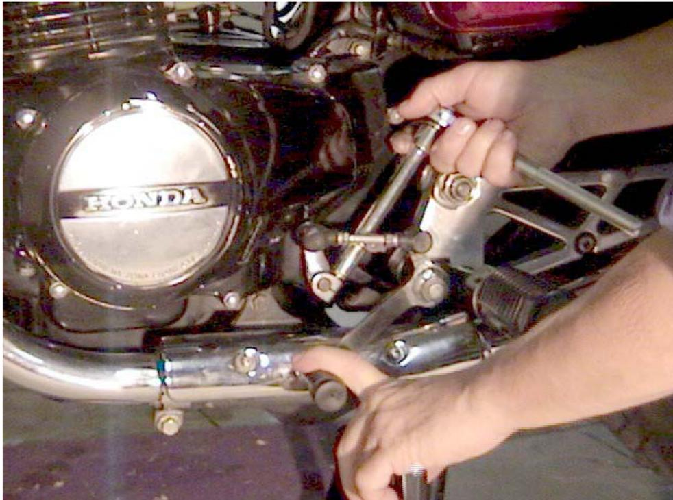
Figura 4 – Remoção do Braço do Pedal de Câmbio
