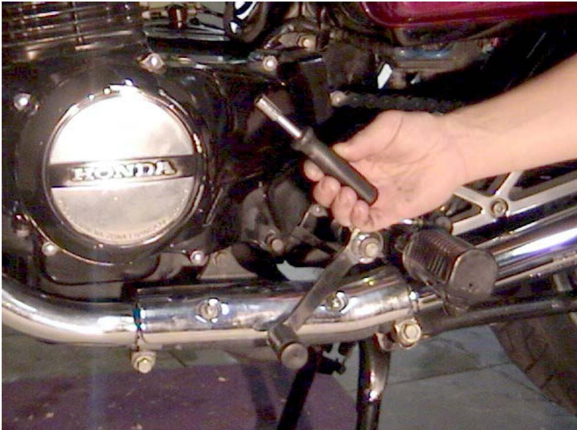
Figura 5 – Remoção da Tampa Lateral Esquerda com Chave adequada de 8 mm
