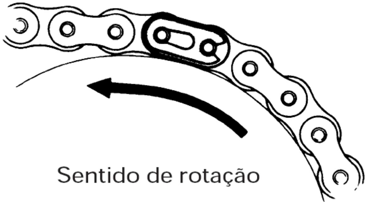
Figura 11 – Instalação da Trava da Corrente de Transmissão
