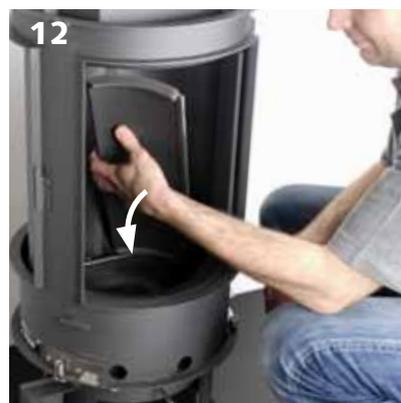
> **A placa traseira:** retirar o parafuso de pressão que mantém a base do desviador no lugar. Levantar a base do desviador [foto 13] e puxar a placa traseira para frente [foto 14]. Inclinando-a pela abertura do recuperador.
