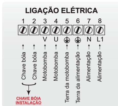
Figura 3 - Esquema de ligação elétrica
