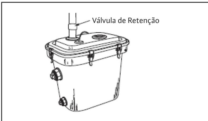
2. Instale uma válvula de retenção na tubulação de saída da caixa para proteger a bomba do fluxo de retorno.
