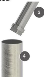
Para retirar o estepe, conecte a chave (2) no corpo principal (4), posicionando-as da mesma forma e gire a chave manualmente no sentido anti-horário até retirar o dispositivo.
