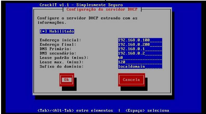
Os endereços Inicial e Final definem uma extensão de endereços IP que o servidor DHCP irá fornecer aos computadores de sua rede quando eles pedirem um endereço IP. Não use toda a extensão de rede para o DHCP. No mínimo deixe de fora o endereço IP do CRACKIT MV.
