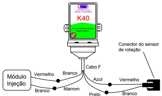
Instalação FIAT Fire 1.0/1.3 V8 Motor HP módulo Marelli(2003/04)
