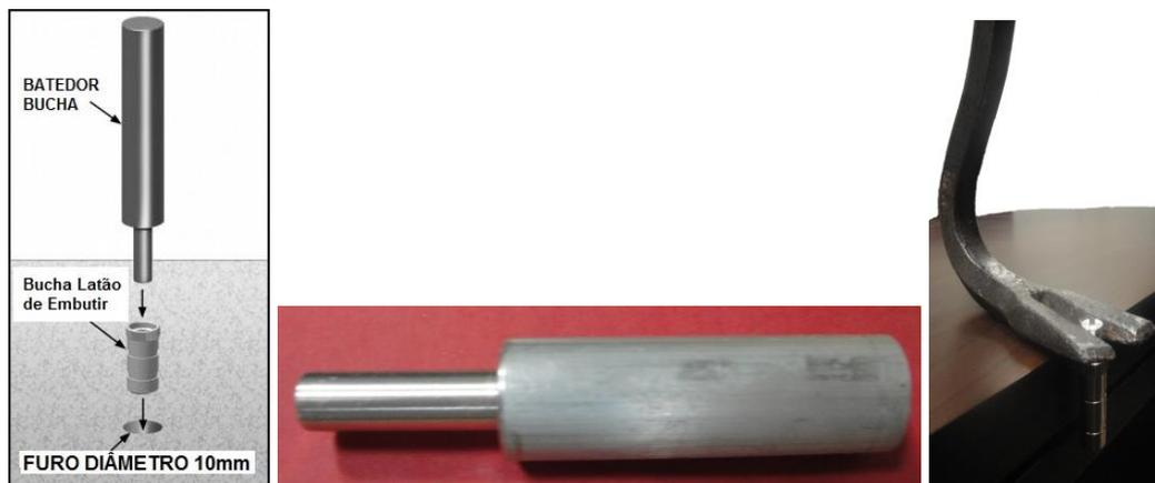
\*Recomendamos sempre posicionar a furação do piso centralizado de acordo com as argolas de ancoragem do pino-bucha, bem como fazer a furação sempre a 90° em relação as argolas de aço Inox da Capa Piscina. Ocorrendo erro de marcação dos pontos de fixação do pino bucha recomendamos utilizar a ferramenta pé-de-cabra com comprimento de 80cm de cabo para facilidade da extração do pino bucha ora embutido. Refazer a furação e reinstalar conforme orientação em nosso manual de instalação.
