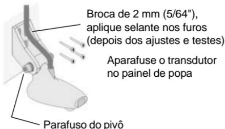
parafusos forem apertados, as cabeças dos parafusos alinhem-se com o casco.
