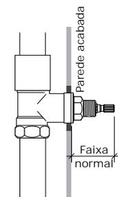
Durante a instalação de acabamentos em bases de registros de pressão ou gaveta, podem ocorrer problemas provenientes de posicionamento, resultando em registros enterrados ou salientes.
