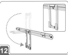
Após encaixado, vire o Organizador de cabos de forma que os ganchos fiquem voltados para você - veja posição correta no detalhe da ilustração acima.
