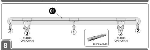
Posicione a Chapa Base (01) na parede, nivele e marque os locais dos furos "1" e "2" ou mais "3" (opcionais), conforme preferir - nos furos oblongos "2" marcar no centro. Fure a superfície (parede) nos locais marcados e coloque as buchas S-10.
