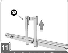
Para encaixar o Organizador de cabos (08), coloqueo de cabeça para baixo, com os ganchos voltados para a parede, como na ilustração acima.
