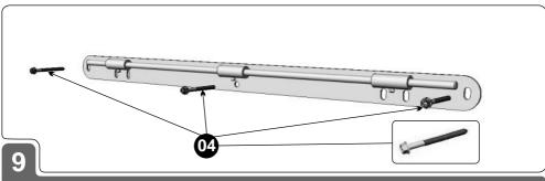
Fixe a Chapa Base na parede utilizando os Parafusos Sext. 1/4" x 65 mm (04)
