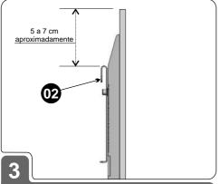
Fixar as Hastes LEDtv (02) de forma que seu gancho superior fique o mais próximo possível de 5 a 7 cm de distância da parte superior da Tv. Uma distância maior que essa pode atrapalhar quando você for inclinar a Tv para fazer uma manutenção de cabos (energia, HDMI, áudio e vídeo, etc.). Também não é recomendável que a distância sugerida seja muito inferior a 5 cm.
