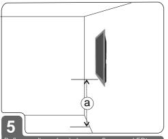
Defina a altura desejada para fixar sua LEDtv na parede, medindo do chão até um ponto que deva ficar a base inferior de sua LEDtv. (altura "a").
