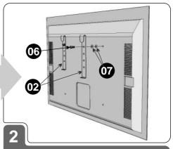
Deite sua LEDtv em uma superfície macia de modo que a parte traseira fique voltada para você. Fixe nos furos superiores as Hastes LEDtv (02), utilizando os Parafusos philips M8 x 16 mm (06), e entre as hastes e a Tv, coloque as Arruelas plásticas (07) - 2 em cada haste -, conforme indicado acima.
