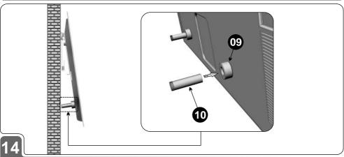
Incline sua LEDtv e encaixe os Distanciadores (10) nos Knobs (09) fixados na parte inferior da Tv *(vide Etapa 3).* Esses distanciadores auxiliam você fazer a instalação e manuseio dos cabos (energia, HDMI, áudio e vídeo etc.) e para fixar as Travas do Suporte (03) nas Hastes do LEDtv (02), mantendo a LETtv inclinada.
