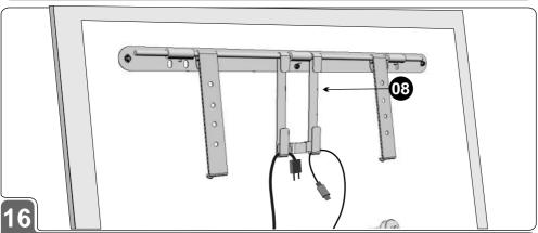
Passe todos os cabos (energia, HDMI, audio e vídeo etc.) pelo Organizador de Cabos (08), como indicado acima. Essa peça tem a função de evitar emaranhados de fios na parte traseira do aparelho, e também o contato ou entrançamento entre os cabos, que pode ocasionar ruídos, ou defeitos na decodificação de sinais de audio e vídeo.
