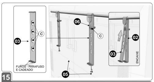
Encaixe as Travas do Suporte (03) nas Hastes LEDtv (02), conforme indica detalhe à direita da imagem acima. Note que os furos na Trava do Suporte "c" deve encaixar-se na cabeça do Parafuso philips M8 x 16 (06). Na dobra inferior da Trava (03), existem dois furos; em um deles, fixe um Parafuso philips M5 x 10 (05) - um em cada trava -, e aperte. No outro furo, é possível inserir um cadeado, para evitar a remoção do aparelho.
