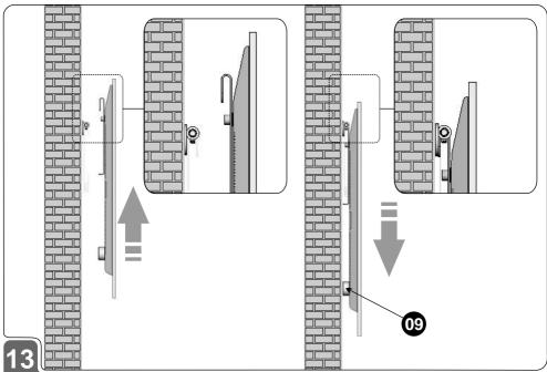
Levante sua LEDtv, na posição vertical, e encaixe as Hastes LEDtv (02) fixadas em sua traseira, na haste guia do Suporte fixado na parede, então desça a Tv lentamente e encoste os knobs (09) na parede.
