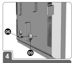
Nos furos inferiores do LEDtv, fixe os Knobs (09), utilizando os outros dois Parafusos philips M8 x 16 (06) - um em cada knob.
