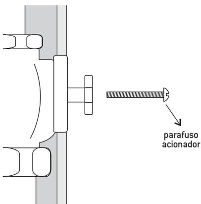
Atarraxe o novo parafuso, encoste o gabarito de alinhamento na parede e gire o parafuso acionador, com a mão, até que encoste na marcação.
