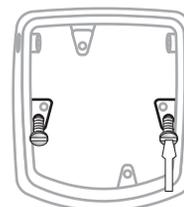
Encaixe o botão na base do acabamento, primeiramente a parte inferior e depois encaixe a parte superior fixando com os parafusos.
