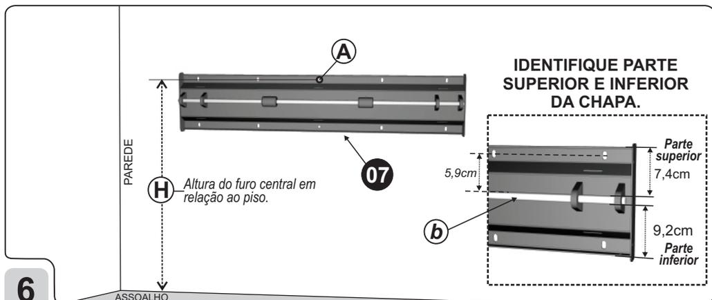
Para encontrar a altura ideal (**H**) para fixar a Chapa do Suporte **07**, utilize a soma das alturas obtidas nas etapas **3** e **4** e adicione 5,9 cm ( $H = x + y + 5,9 \text{ cm}$ ). Essa altura indica o ponto ideal para marcar o furo central superior (**A**) da Chapa **07**.
