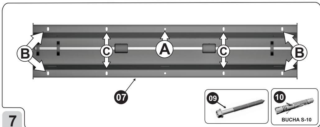
Posicione a Chapa do Suporte **07** na parede, marque o local do furo central superior (**A**), fure e fixe a bucha S-10 **10**. Em seguida, fixe um Parafuso Sext. **09** no furo central superior, mas não dê o aperto final. Nivele a chapa e marque no centro dos furos oblongos (**B**). Retire o parafuso central e fure a superfície (parede) nos locais marcados e coloque as Buchas S-10 **10** restantes.
