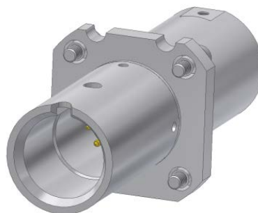
Figura 13. Receptáculo montado com Flange Stab
