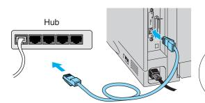
Ligue o cabo de interface de rede à impressora e, em seguida, ligue-o a uma porta disponível no hub.
