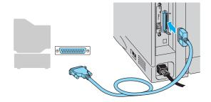
Ligue o cabo de interface paralela ao computador e, em seguida, ligue-o à sua impressora.
