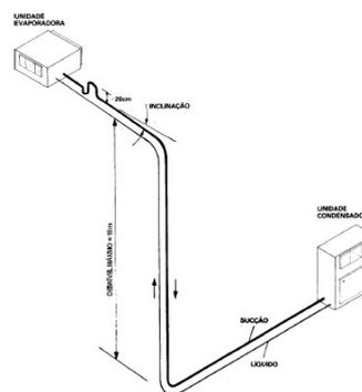
j) todas as dobras na tubulação de cobre deverão ser feitas com o auxílio de ferramenta adequada (mola de dobramento), para evitar estrangulamento dos tubos. Em hipótese alguma poderão ser feitas curvas nos tubos com as mãos;
