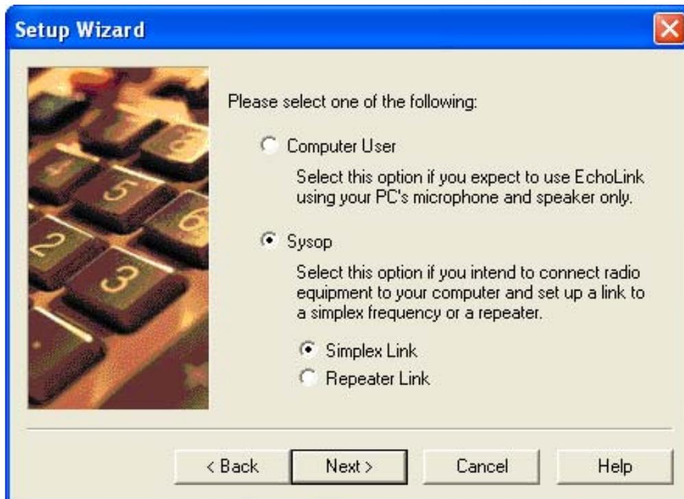
Escolha *Sysop* e *Simplex Link* para operar numa frequência direta, ou *Sysop* e *Repeater Link* para operar uma frequência de repetidora.
