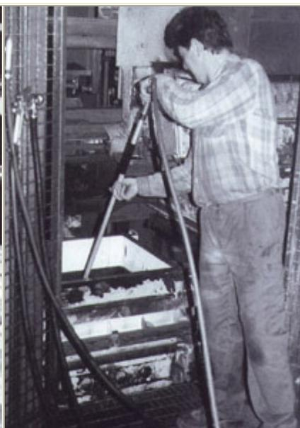
Pistola Amplificadora de vazão com 1000 mm utilizada para limpeza em moldes de fundição de alumínio.
