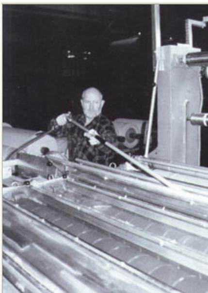
Pistola Amplificadora de vazão com 1500 mm utilizada para limpeza de cilindros na Indústria de Papel.
