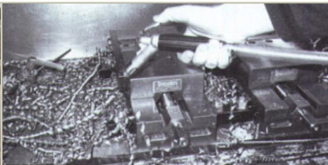
Pistola amplificadora de vazão Silvent 755 utilizada na limpeza de cavacos de aço.
