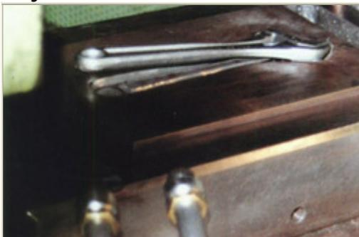
Na Indústria de fundição. A Sandvik Bacho utiliza dois bicos Silvent 705 para retirar uma chave inglesa do molde. Anteriormente, isto era realizado com um tubo aberto de 10 mm. A instalação dos bicos Silvent reduziram o ruído a mais da metade e permitiram uma redução no consumo de ar de 49%.
